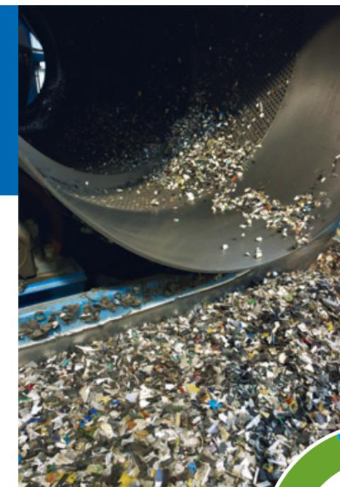
Eine Siebtrommel trennt das Granulat in zwei Größen
