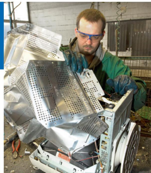
Bildschirmgeräte werden von Hand demontiert
